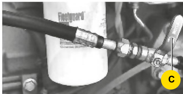
Закрытый кран контура циркуляции горячей охлаждающей жидкости
